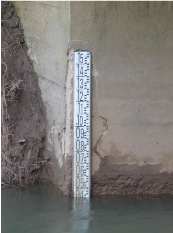
Image : Une échelle limnimétrique pour mesurer la hauteur d'eau (source : Artois-Picardie Eau France)
